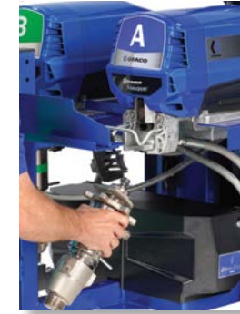
3. Hortumu çıkarın ve pompayı dışarı kaydırın
